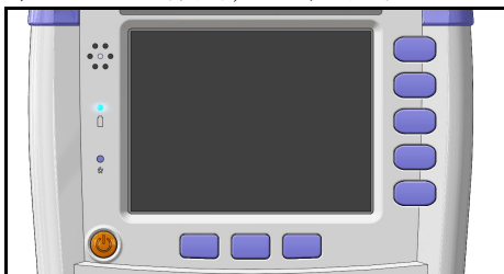
图 3-3 充电指示灯，充电时显示为蓝色
